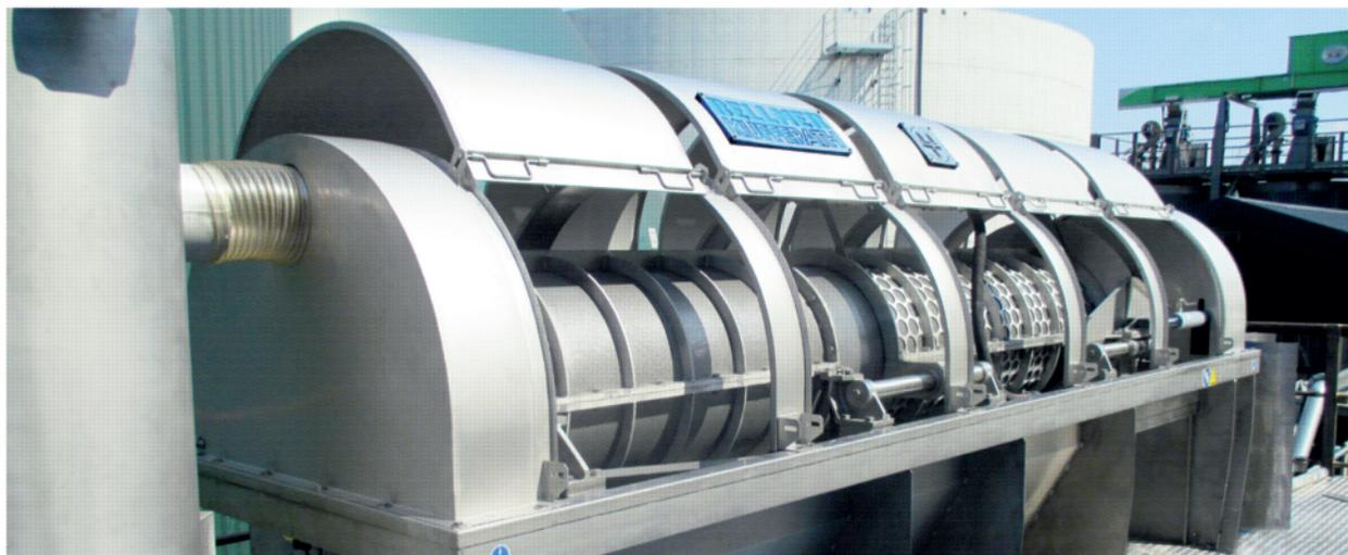
deshidratado de digestatos por vía húmeda, la segunda etapa del deshidratado por vía seca, y el tratamiento de lodos de estaciones depuradoras de aguas residuales (EDAR) o efluentes con baja carga estructural. La Akupress BX destaca por su capacidad para reducir el consumo de polímeros y su fácil ajuste, mejorando la eficiencia operativa con un desgaste mínimo de componentes.
