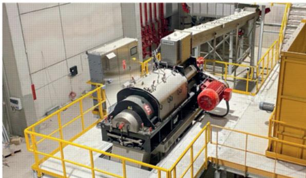
El **Hidrociclón CS300** garantiza que el flujo orgánico que llega a los digestores sea de la mayor calidad, al eliminar materiales inertes pesados, como vidrio, huesos y cáscaras. Por su parte, el **Windshifter WS800**, un separador de aire, facilita la separación eficiente entre materiales ligeros y pesados, lo que aumenta significativamente la recuperación de la materia orgánica.
