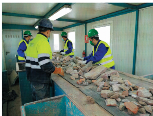
Cabina de triaje de la planta de Recinor donde se clasifican y seleccionan los residuos. Fuente: Recinor
