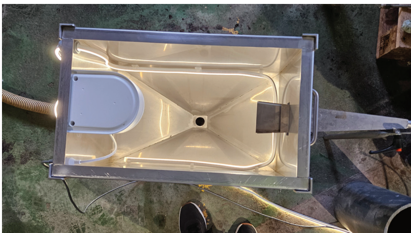
FIGURA 2. Equipamiento para monitorizar el escurrido
