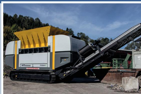
**EL XR2000/3000 LA POTENTE TRITURADORA DE UN EJE PARA EL TRATAMIENTO DE LOS MATERIALES MÁS DIVERSOS**
