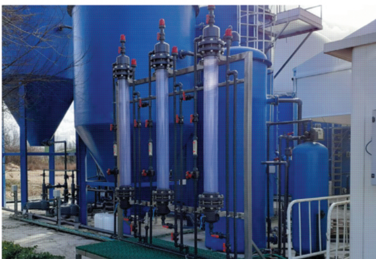
FIGURA 4. COLUMNAS CON DIFERENTES MATERIALES ADSORBENTES PARA LA CAPTACIÓN DE FÓSFORO FIGURE 4. COLUMNS WITH DIFFERENT ADSORPTION MATERIALS FOR PHOSPHORUS CAPTURE
