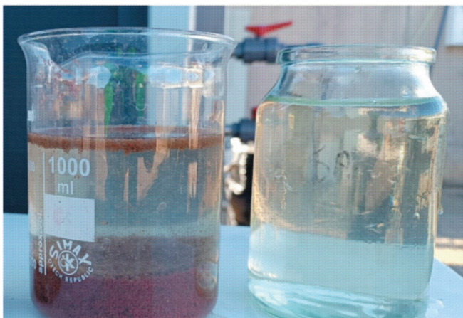
FIGURA 11. Izquierda: biomasa anammox decantada de la planta piloto. Derecha: efluente del reactor anammox.
