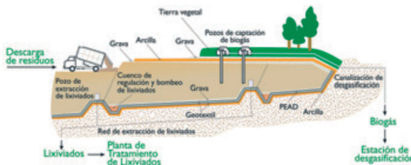
Esquema sección del vertedero de Las Dehesas
