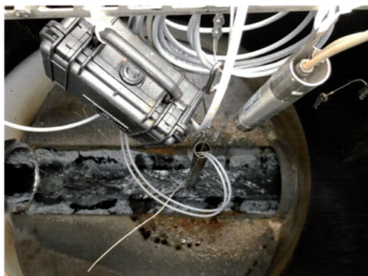
FIGURA 2. El sensor SulfiLogger mide el H 2 S directamente en las aguas residuales y en el aire. FIG 2. The SulfiLogger sensor measures H 2 S directly in the sewer.
