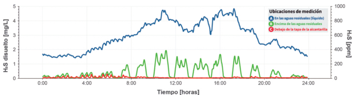
FIGURA4. Gráfico de mediciones del H 2 S en el caso de estudio. FIG 4. Graph of H 2 S measurements in case study.
